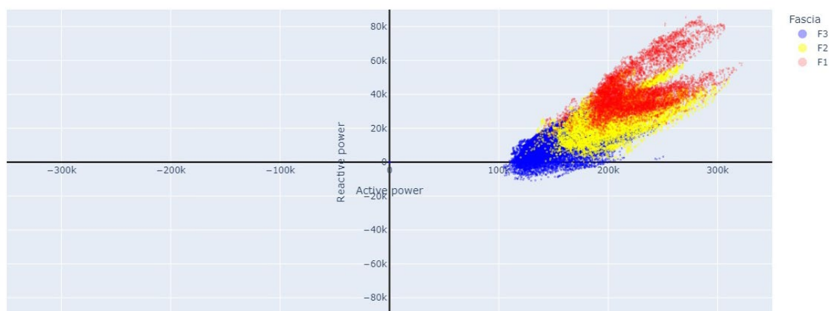
Figura 58. Misura con riferimento a 4 quadranti dei flussi di potenza misurati, con risoluzione quartoraria per l'anno 2016, nell'intero set di CP in analisi – area di Napoli (potenza in kW/kvar).
