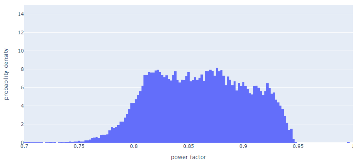
Figura 47. Distribuzione di probabilità del fattore di potenza ricostruito per gli utenti BT di taglia inferiore ai 55 kW per l'anno 2017 – area di Foggia
