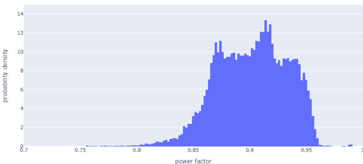
Figura 48. Distribuzione di probabilità del fattore di potenza ricostruito per gli utenti BT di taglia inferiore ai 55 kW per l'anno 2019 – area di Foggia
