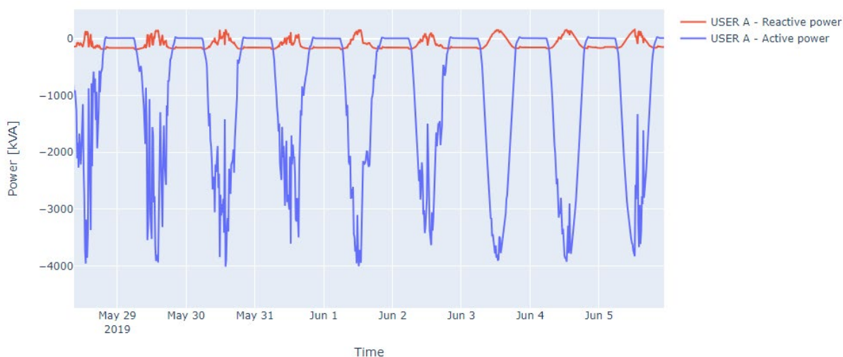
Figura 14. Comportamento capacitivo (nelle ore notturne) di un utente attivo (fotovoltaico), probabilmente associato alla natura capacitiva della rete interna dell'utenza in analisi (valori positivi di P e Q nel grafico corrispondono al funzionamento nel quadrante Q1).
