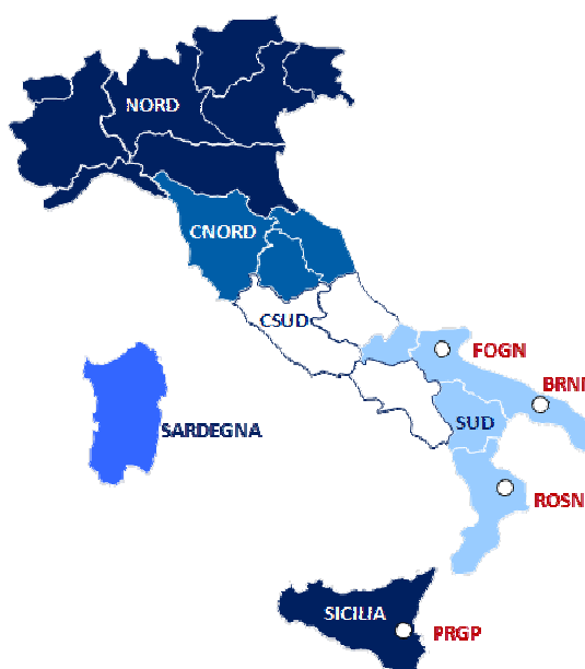
Figura 41 - Conformazione delle zone e dei poli limitati della rete rilevante
