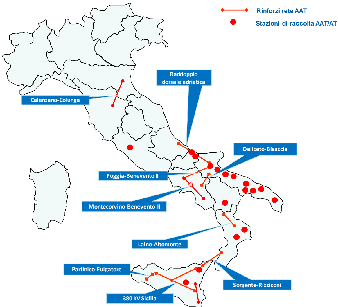
Figura 57 - Principali interventi finalizzati alla maggior produzione da FER sulla rete 380 kV
