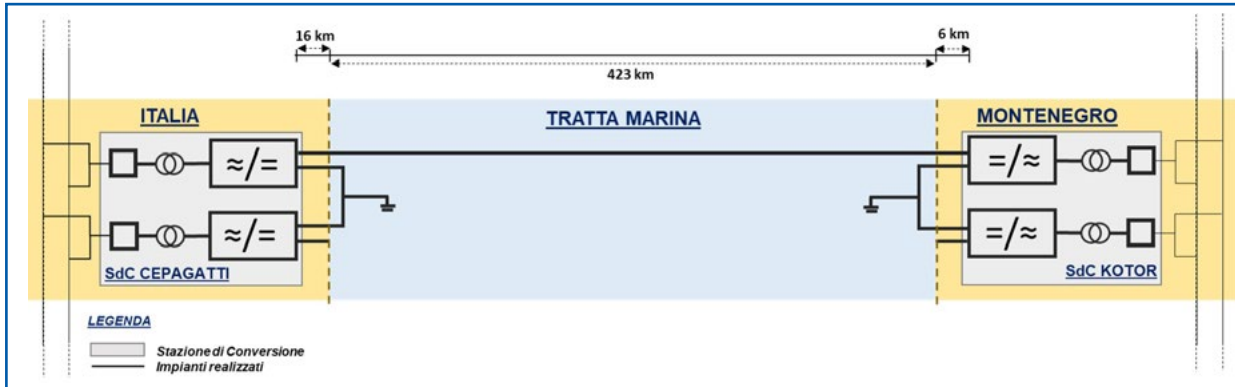
FIGURA 2 Schema elettrico semplificato opere esistenti
